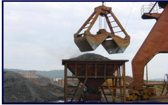
图 17 蛤壳式抓斗起重机、漏斗以及传送带卸载热压铁块
