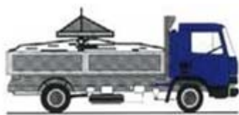
图 19 汽车装载直接还原铁粉（使用前-后反斗车）
