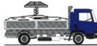
图 19 汽车装载直接还原铁粉（使用前-后反斗车）
