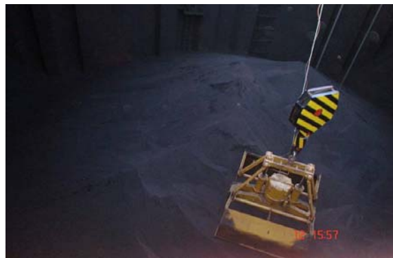
图 17 蛤壳式抓斗起重机卸载直接还原铁铁粉
