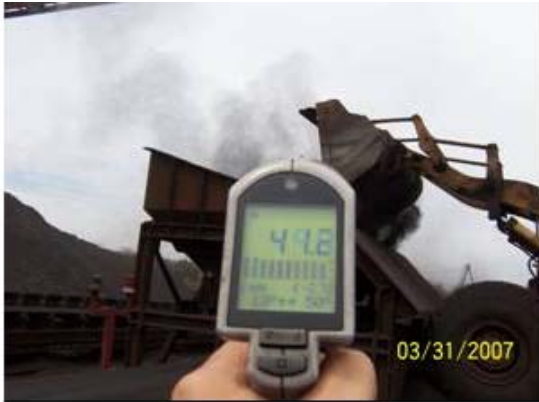
图10-从堆场中转移时须测量温度
