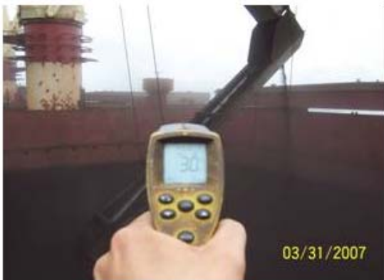
图12-装入船舱时须测量温度
