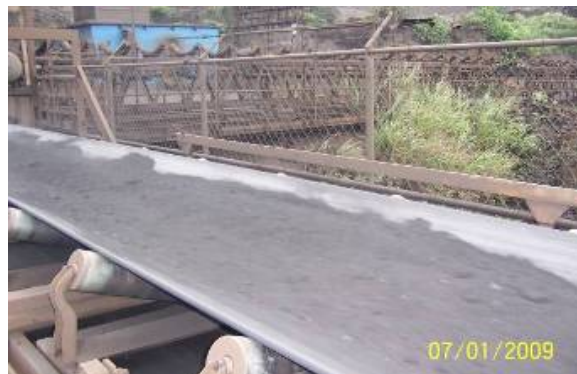
图 18 输送带输送直接还原铁铁粉
