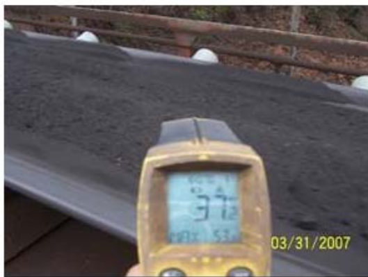
图11-通过传送带运至船舱过程须测量温度
