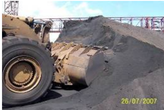
图 16 用前反斗车卸载直接还原铁铁粉
